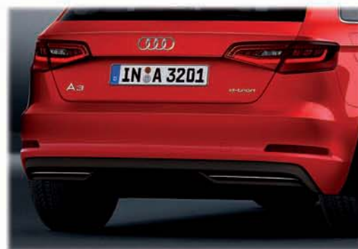
Задний бампер, разработанный специально для e-tron, с диффузорами и декоративными вставками под алюминий и без видимых концевых секций трубы заднего глушителя
